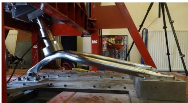
Fig.IV.A.1.b Photo du dispositif de l'essai quasi-statique 2
