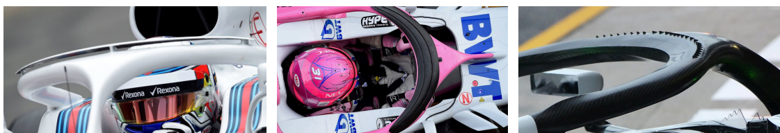
Fig.II.C.3.a De gauche à droite : aileron simple, aileron triple, Générateurs de vortex
