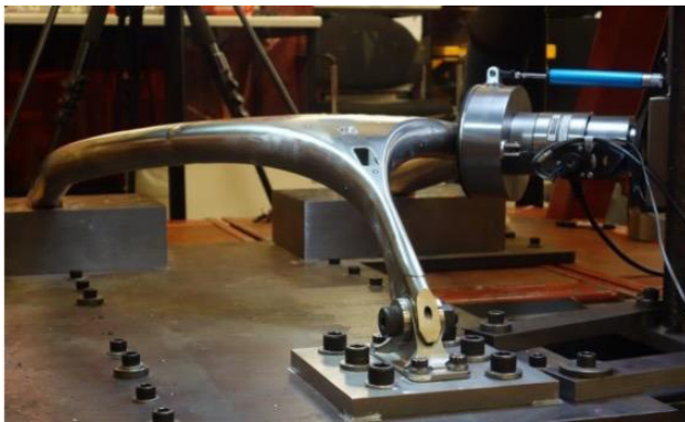
Fig.IV.A.1.a Photo du dispositif de l'essai quasi-statique 1
