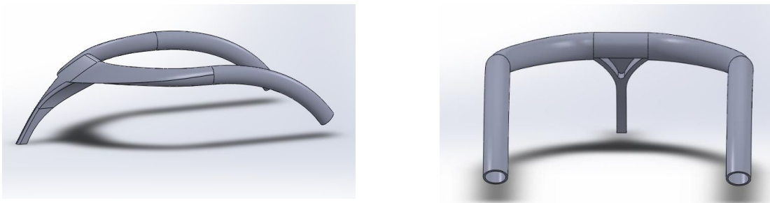
Figure 7.1- Modélisation du halo G sur Solidworks
