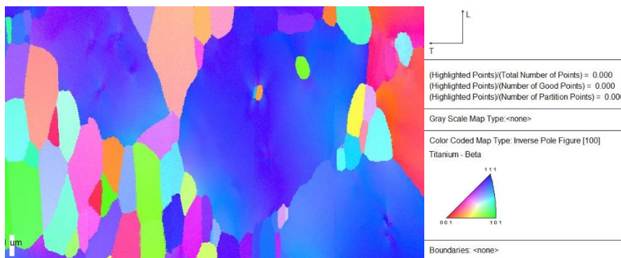
Figure : 17 Orientation moyenne de chaque grain selon un axe orthogonal à la compression (échantillon recuit)
