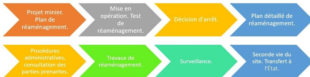
FIGURE 3 – Les différentes phases du réaménagement d'une mine (inspiré d'un graphique d'Orano)
