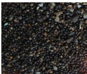
FIGURE 5 – Une résine échangeuse d'ions (Orano)
