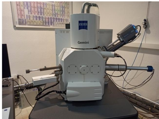
FIGURE 56: Microscope Electronique à Balayage
