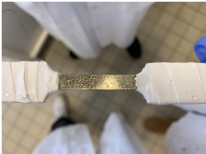
FIGURE 51: Cloques sur X52
