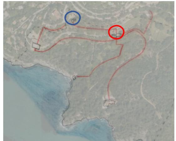
FIGURE 18 – Proposition globale d'un nouveau réseau électrique
