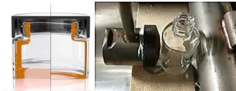
Figure 1 – Illustration de l'objectif visant à réduire la matière d'un pot ou d'un flacon à résistance équivalente.
