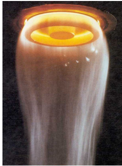
Figure 1 – Procédés de fibrage du verre (a) laine de verre, (b) fibres de renforcement et (c) fibres optique.
